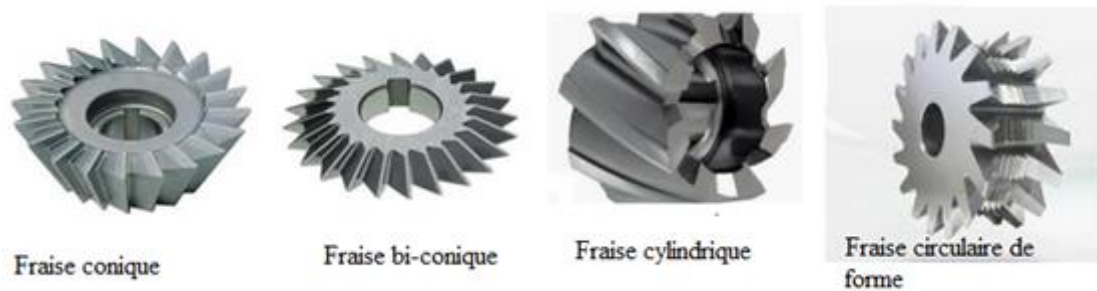
Fig1.6 a) fraise conique b) fraise biconique c) fraise cylindrique d) fraise circulaire de forme
