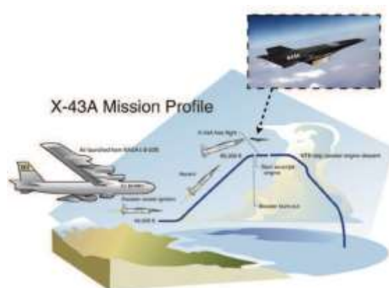
Figure 1.8: Schéma représentant l'ascension du scramjet X43-A en 2004 depuis son lancement depuis le bombardier B-52B [6]
