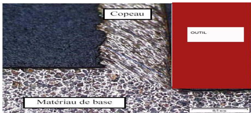
Figure. II.3: Formation du copeau en usinage Conventionnel
