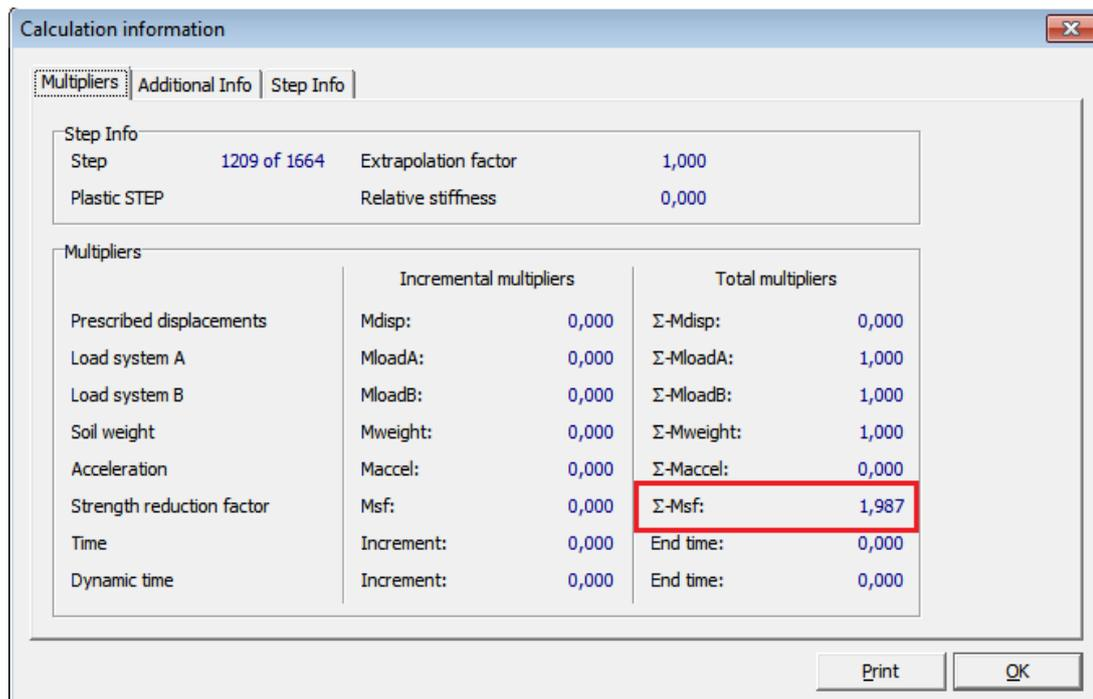
Figure VI.28 : Coefficient de sécurité après le confortement
