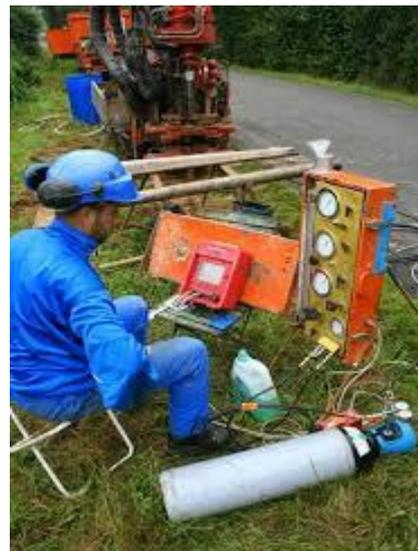
**Figure V.1 :** Sondage au pressiomètre
