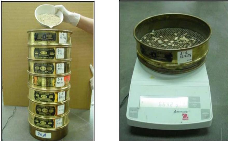
**Figure V. 6:** Appareillage d'analyse granulométrique par tamisage.
