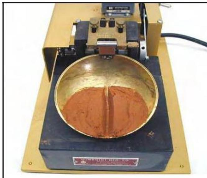
**Figure V. 7:** Appareil de CASAGRANDE.
