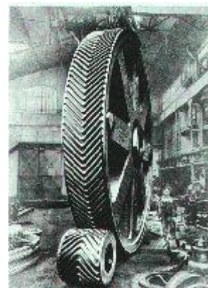
Figure 2.8 : Roue à denture inversée accolées.
