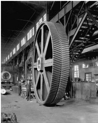
Figure 2.7 : Roue à chevron.
