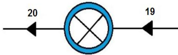
Figure (III.10): Pompe d'alimentation
