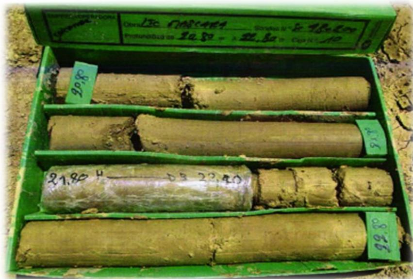
Figure II. 9 : Exemple d'échantillon prélevé du sondage SC1 entre 20,8 m et 22,8 m
