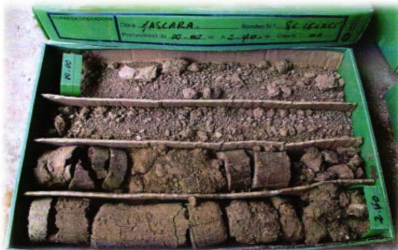
*Figure II. 12 : Exemple d'échantillon prélevé du sondage SC2 entre 00,00 m et 2,4 m*
