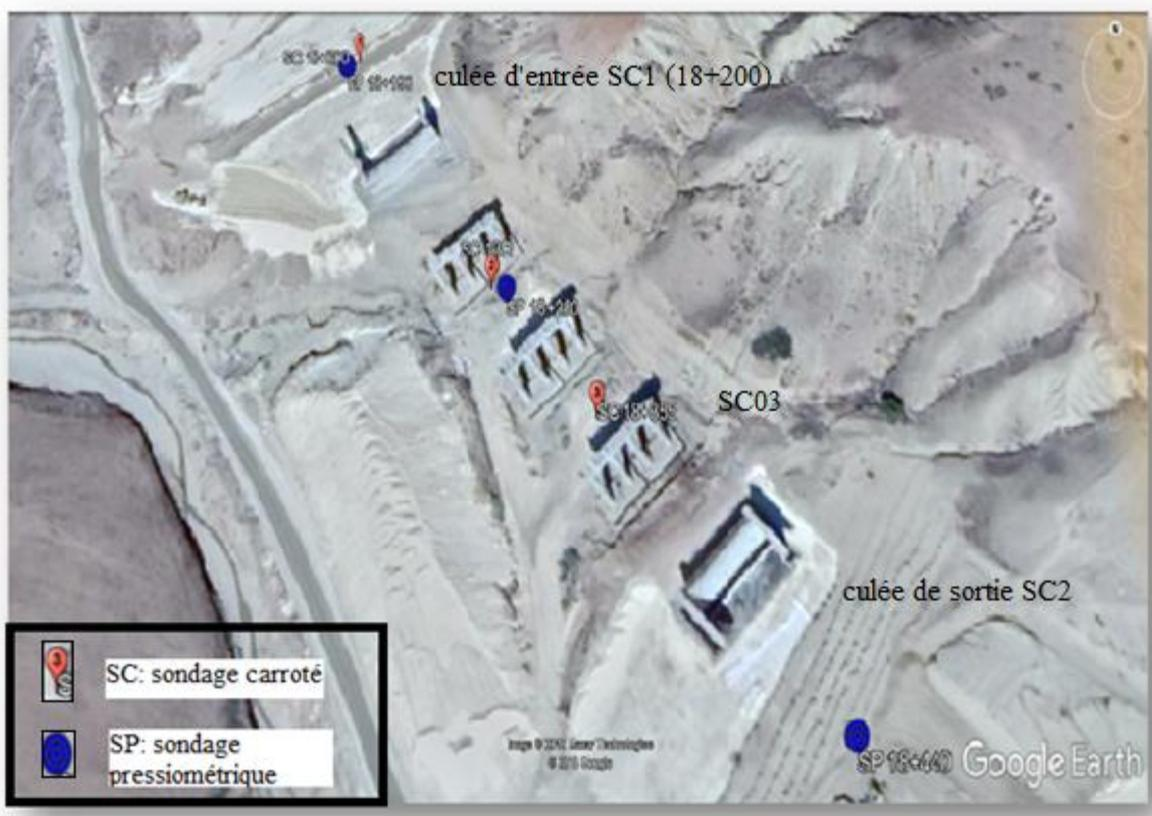
Figure II. 6 : Carte d'implantation des essais in-situ
