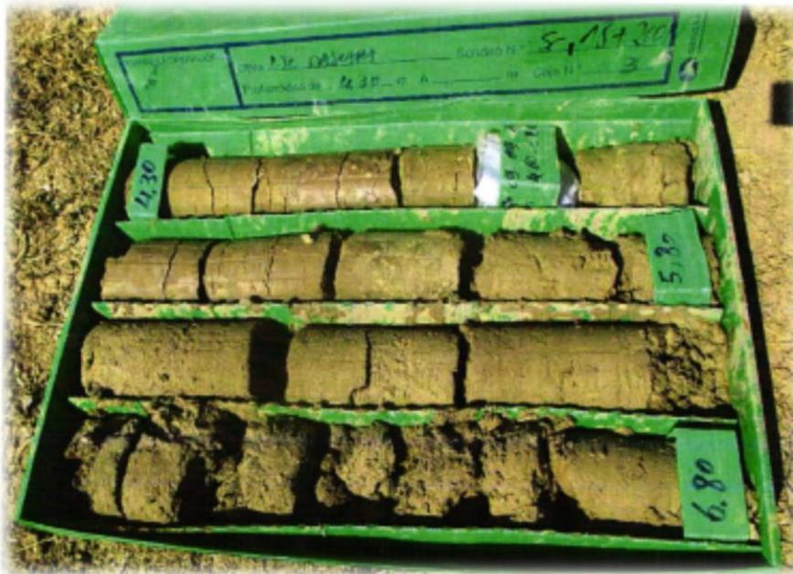
Figure II. 8 : Exemple d'échantillon prélevé du sondage SC1 entre 4,30 m et 6,80 m
