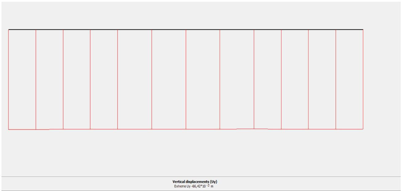
*Figure V.40 : Déplacement de la semelle de la pile.*
