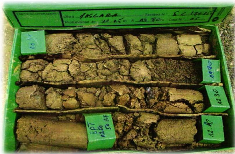
*Figure II. 11 : Exemple d'échantillon prélevé du sondage SC2 entre 10,15 m et 12,8 m*
