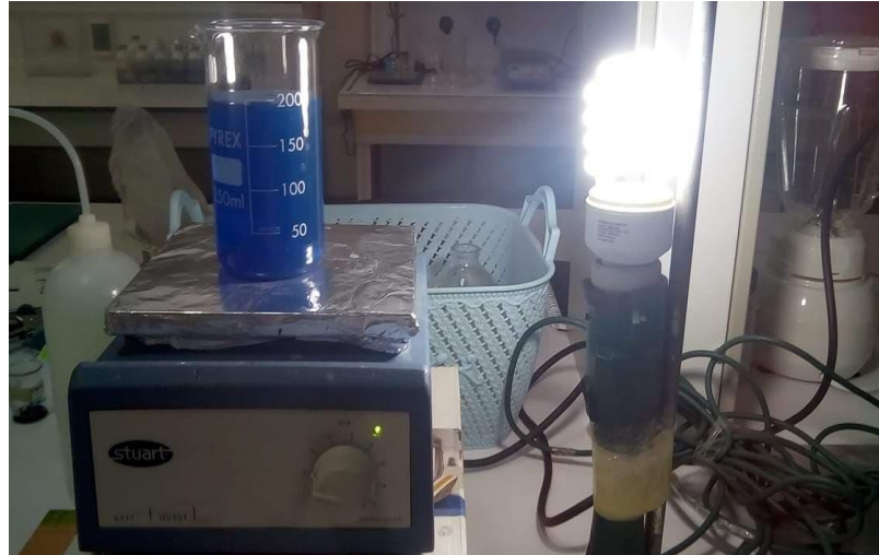
Figure 4.5 : Dispositif expérimental du procédé photocatalytique.
