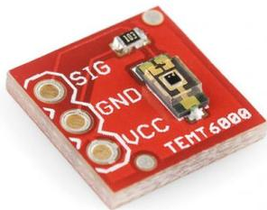
Figure III.31 Capteur de lumière TEMT6000.
