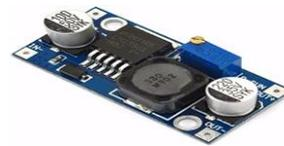
Figure III.20 Le module "LM2596S". [28]
