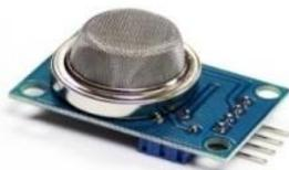
Figure III.29 Capteur de gaz "MQ2".
