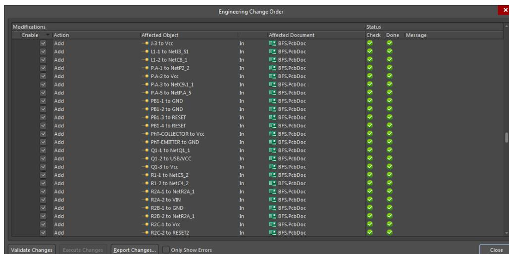
Figure IV.18 Import les composent vers le PCB.
