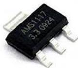
Figure III.21: Le régulateur de tension "AMS1117". [29]
