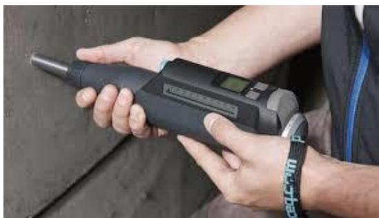
**Figure I.6:** Scléromètre numérique [6]
