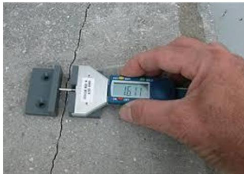
Figure I.8 : Le fissuromètre numérique [3]
