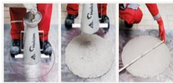
Figure I.15. Essai d'étalement au cône d'abram.
