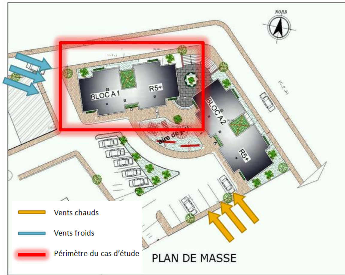
Figure 48: Répartition des vents dominants sur le cas d'étude
