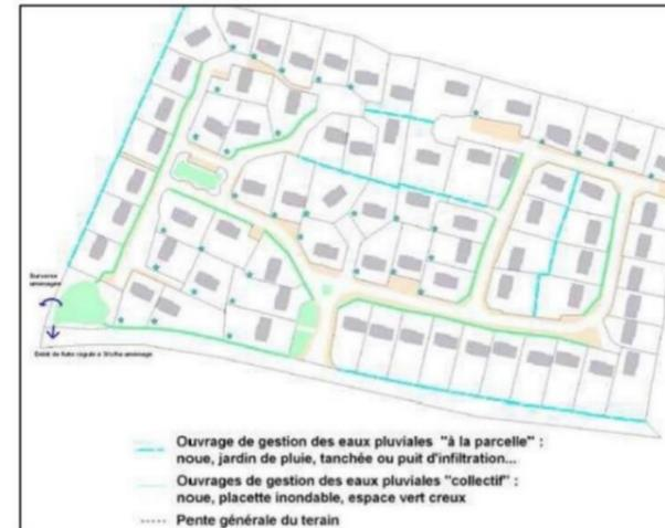
Les ouvrages de gestion des eaux pluviales doivent obligatoirement être équipés d'une surverse (trop plein, déversoir de crue...) aménagée de façon à pouvoir déborder sans causer de dégâts sur l'ouvrage et les avoisinants. Les surverses doivent fonctionner uniquement après le remplissage complet des ouvrages de rétention par des
