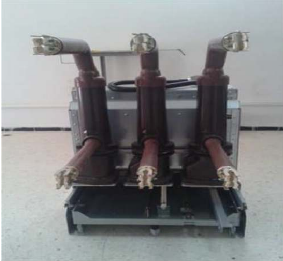
Figure 2.7 : disjoncteur d'une cellule d'un départ d'un poste HTA
