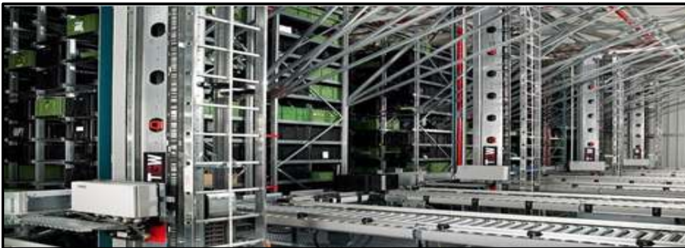
Figure I.12: Mini-Transstockeur double profondeur pour bacs.
