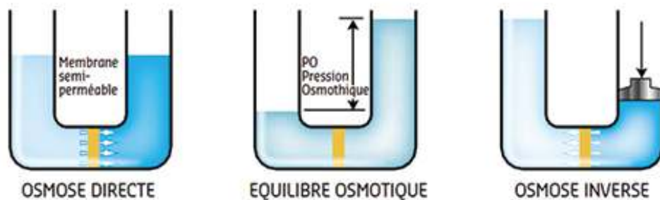
Figure 7 Principe de fonctionnement de l'osmose inverse
