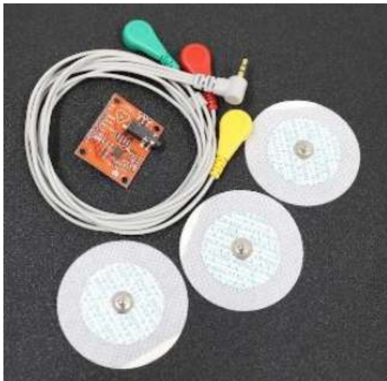
Figure 20 électrodes et câble pour moniteur de fréquence cardiaque AD8232 [14]
