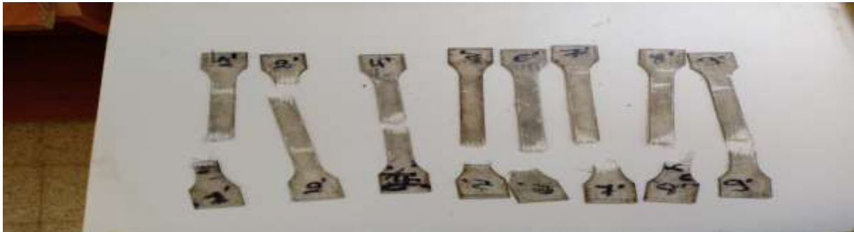
Figure IV.9: Les éprouvettes de type B après la rupture
