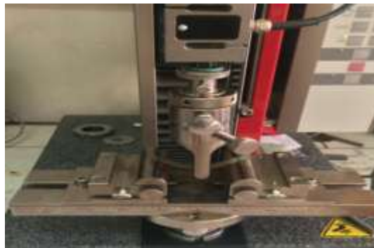
Figure IV.18 : Essai de flexion 3 point pour l'éprouvette de type B
