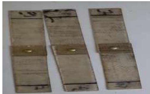
Assemblage avec un seul rivet (1R)
