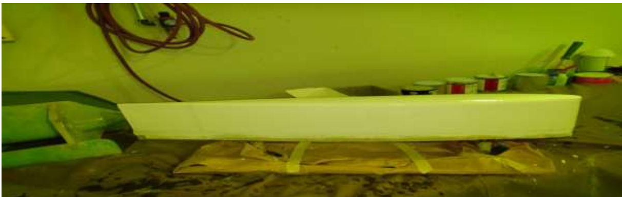
Figure III.4 : L'application d'une couche de gelcoat
