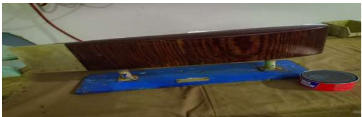
Figure III.2 : Moule positif du saumon positif du Zlin 142
