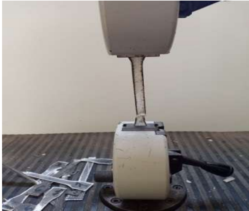
Figure IV.11 : Rupture de l'éprouvette de type C après l'essai de traction
