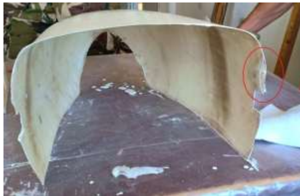
Figure III.8 : Délaminage au sein d'un composite
