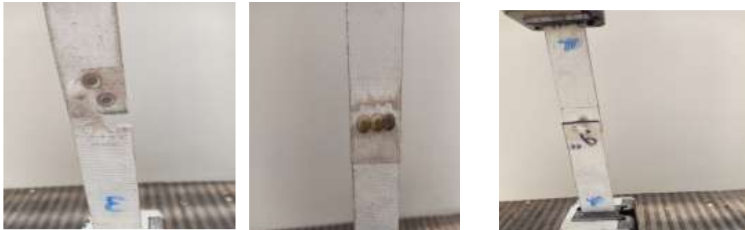
Figure IV.28 : Rupture des échantillons de type simple
