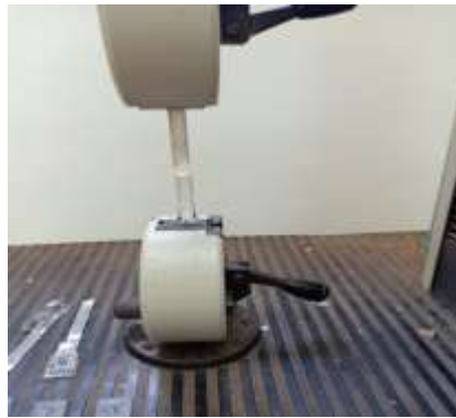
Figure IV.8 : Rupture de l'éprouvette de type B après l'essai de traction
