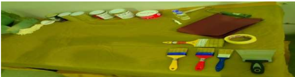
Figure III.1 : Les moyens nécessaires pour le moulage en contact
