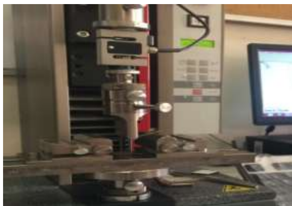
Figure IV.20 : Essai de flexion 3 point pour l'éprouvette de type C
