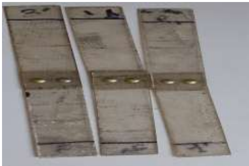
Assemblage avec deux boulons longitudinaux (2RL)
