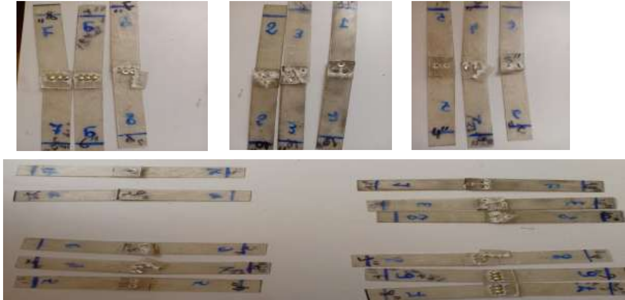
Figure IV.31 : Eprouvette de type C sous effet de traction simple
