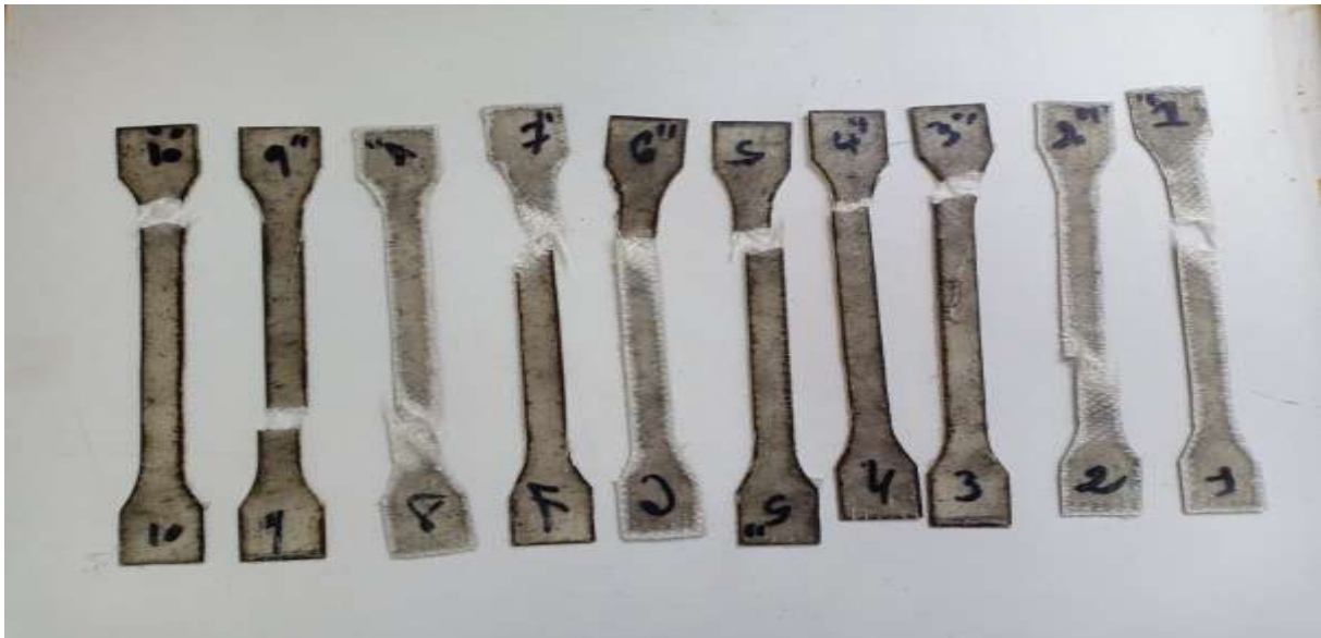
Figure IV.12 : Les éprouvettes de type C après la rupture
