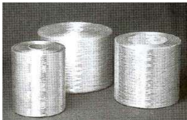
Figure II.16 : Différentes présentations des stratifils
