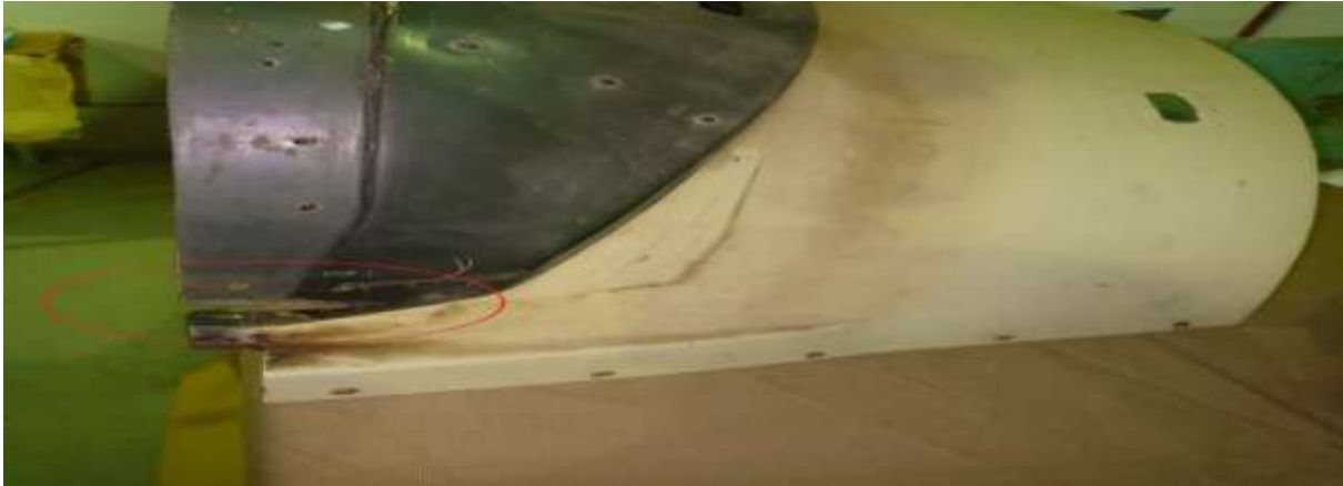
Figure III.7 : Multi fissuration au sein d'un composite
