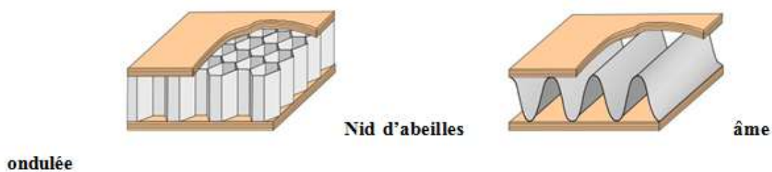
Figure II.12 : Matériaux sandwichs à âmes creuses
