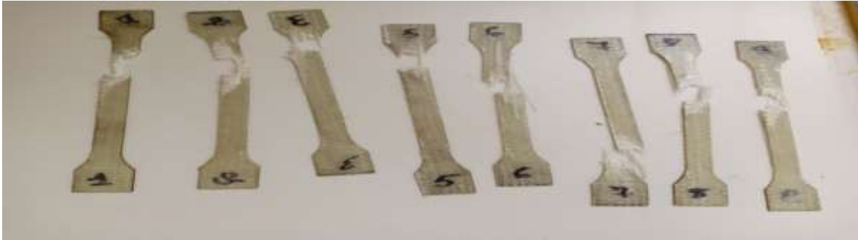
Figure IV.6 : Les éprouvettes de type A après rupture 1
