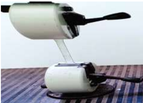
Figure IV.4 : Traction simple sur éprouvette type A
