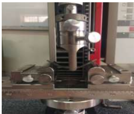
Figure IV.16 : Essai de flexion 3 point pour l'éprouvette de type A
