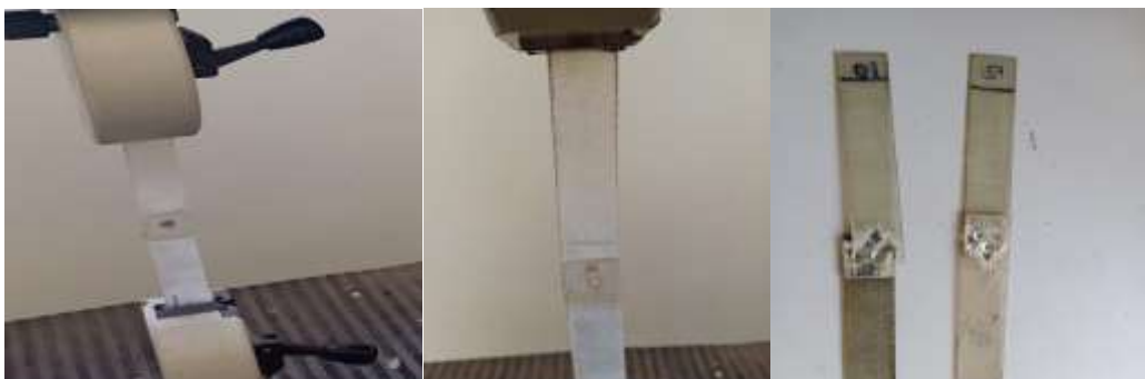
Figure IV.25 : Les éprouvettes de type A après la rupture sous effet de traction simple
