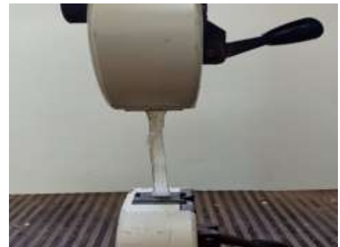
Figure IV.5 : Rupture de l'éprouvette après une traction simple
