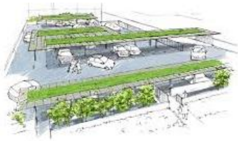
Figure 14: panneaux photovoltaïques au-dessus des aires de stationnements.
