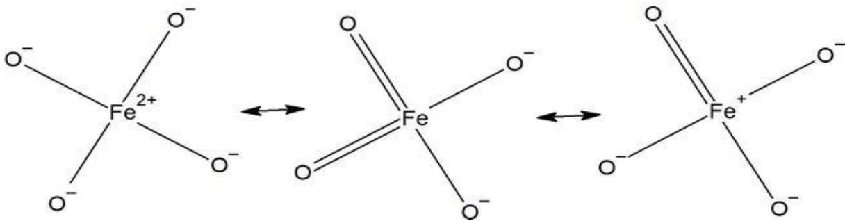
Figure I.2 : Structure hybride de résonance de l'ion de Fe « VI ».
