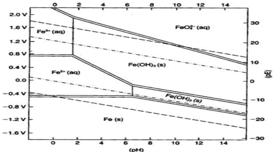
**Figure I.3 :** Diagramme approximatif  $E=f(\text{pH})$  des composés les plus répandus du fer.
