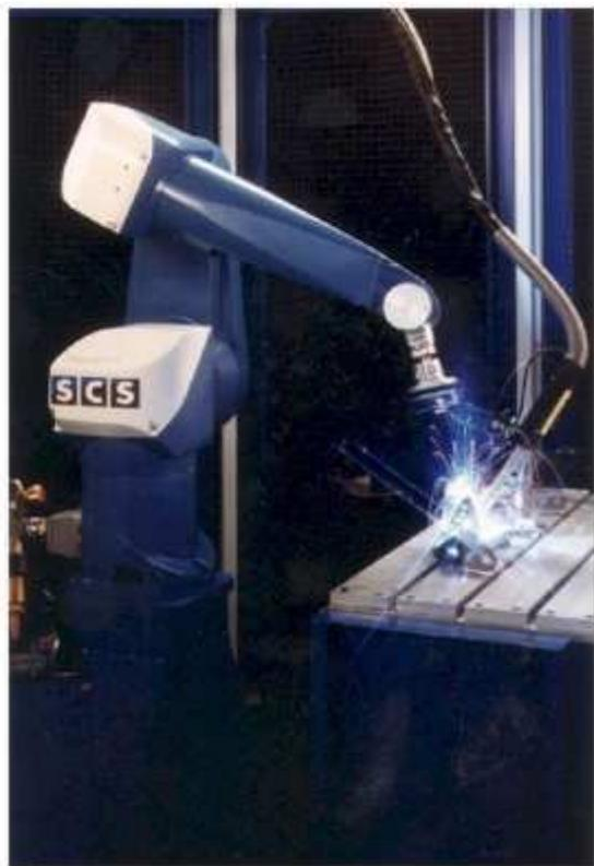
Figure I-18 : Robot de soudage a l'arc
