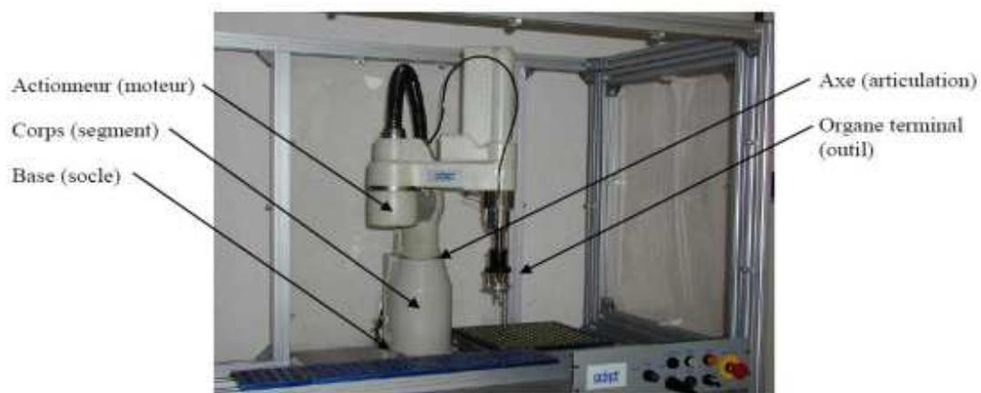
**Figure I.10 :** Architecture d'un robot.
