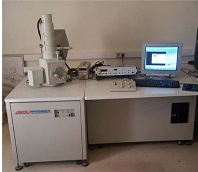
Figure 3.4 : Microscope électronique à balayage MEB (JEOL JSM) de CDTA.
