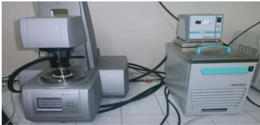
Figure 3.3 : Rhéomètre Anton Paar Modular Compact Rhéomètre MCR 30
