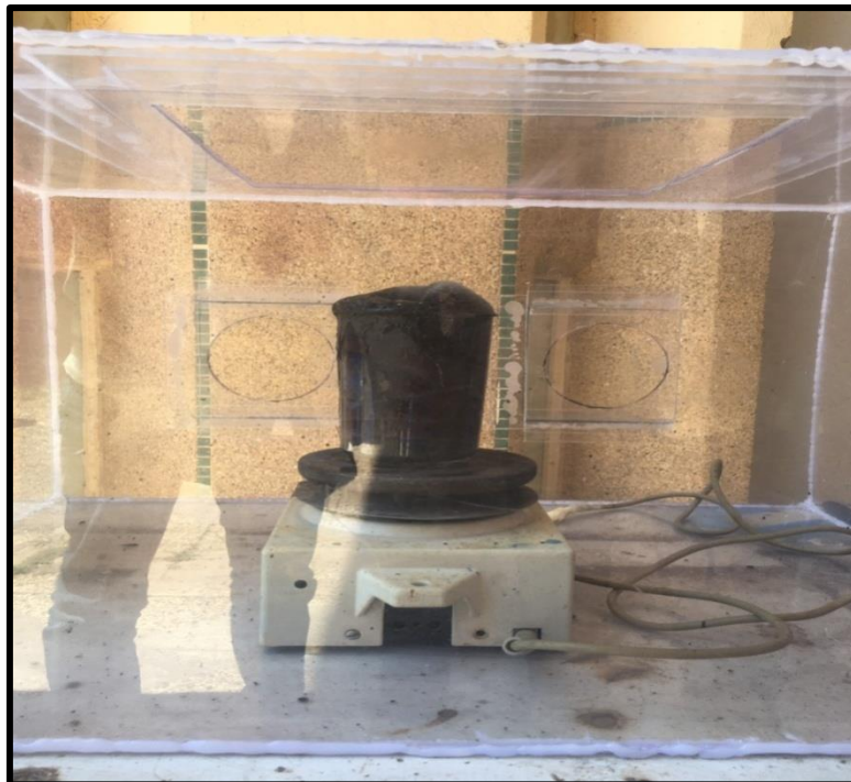
Figure III.7 : La poudre de Ti_2AlC lors du traitement.
