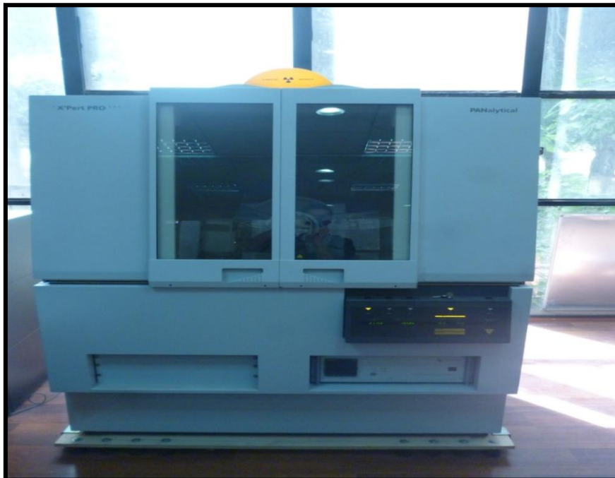
FigureIII.12: Un diffractomètre de type PANALATICAL X'pert Pro.
