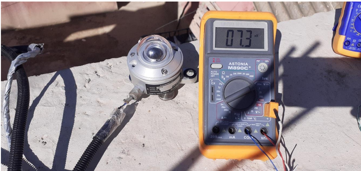
Figure (III-4) : Méthode utilisé pour la mesure de l'éclairement
