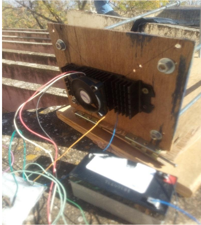
Figure (III -5) : Le refroidissement de la cellule
