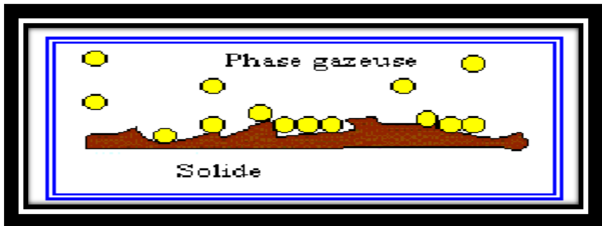
Figure 2: Schéma simplifié représentant le phénomène d'adsorption
