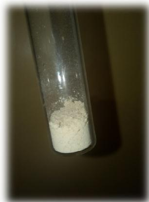
**Figure 10 : Photo montrant le support Mt-Na résultante du traitement de la bentonite brut**
