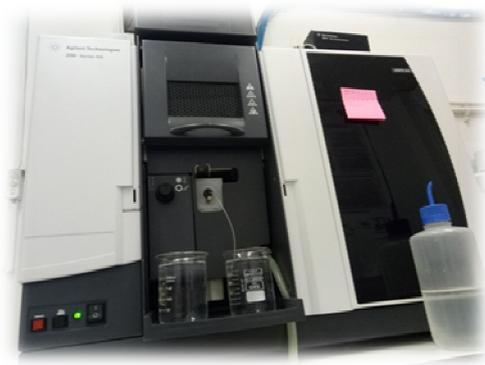
Cette méthode d'analyse élémentaire impose que la mesure soit faite à partir d'un analyte (élément à doser) transformé à l'état d'atomes libres. L'échantillon est porté à une température de 2000 à 3000 degrés pour que les combinaisons chimiques dans lesquelles les éléments sont engagés soient détruites.
