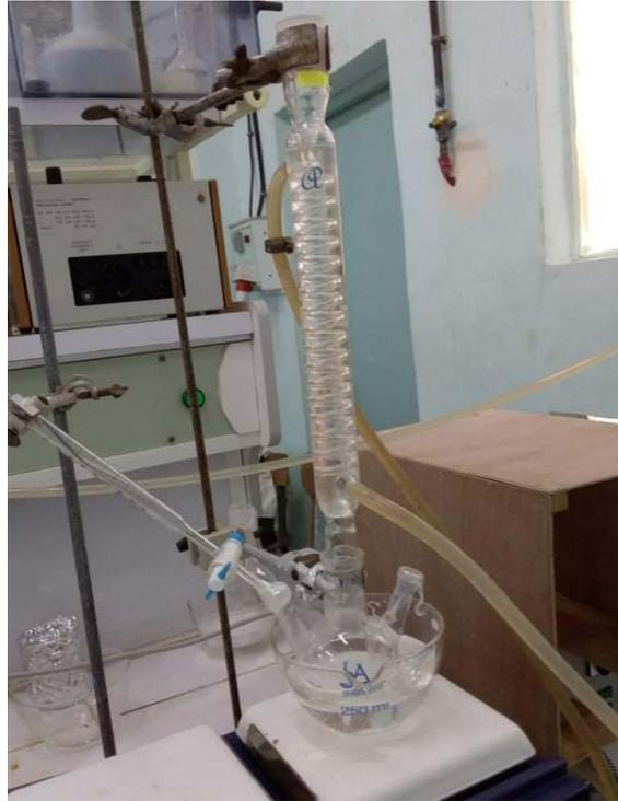
Figure IV.24 : un montage à reflux pour ajouter le silicate de sodium
