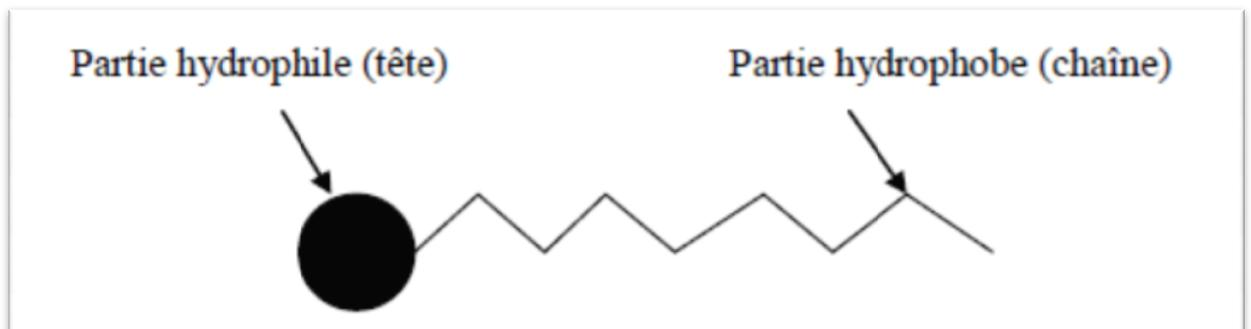
Figure II.7 : Représentation schématique d'une molécule de tensioactif. [30]
