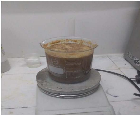
Figure IV.19 : le mélange de la biomasse et l'acide nitrique.
