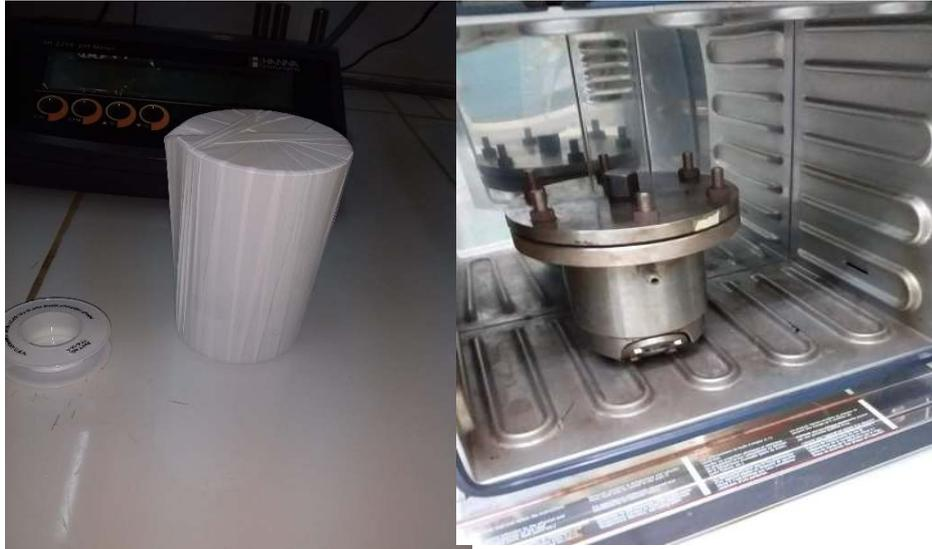
Figure IV.26 : le placement de la solution dans l'autoclave hydrothermique
