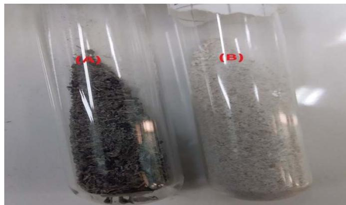
Figure IV.1 : les poudre des tests de calcination ; A) la première méthode, B) la deuxième méthode.
