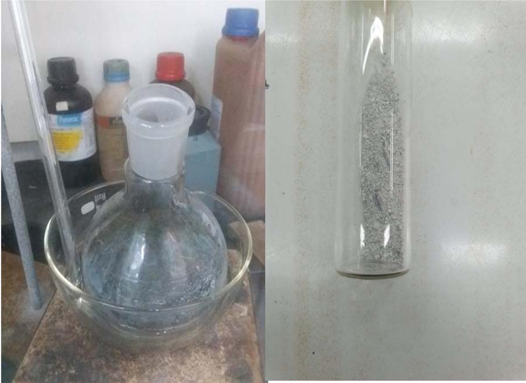
Figure IV.10 : Le mélange de la biomasse et le HCl Figure IV.11 : La poudre de silice.
