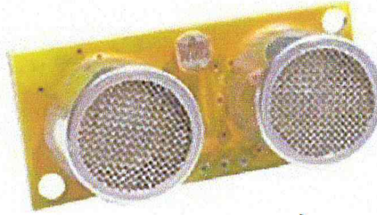
Figure B.2 : Capteur ultrasonore (Émetteur/Récepteur).
