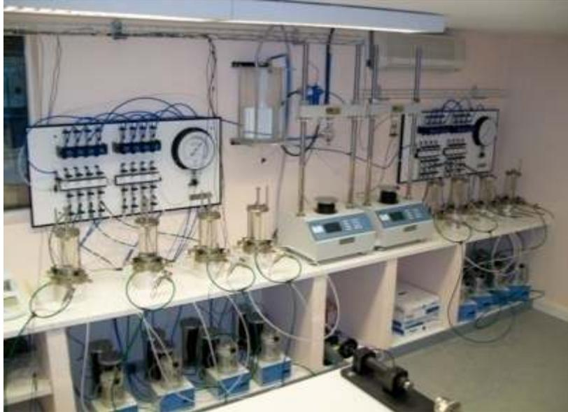
**Figure V.9** essai triaxiale.
