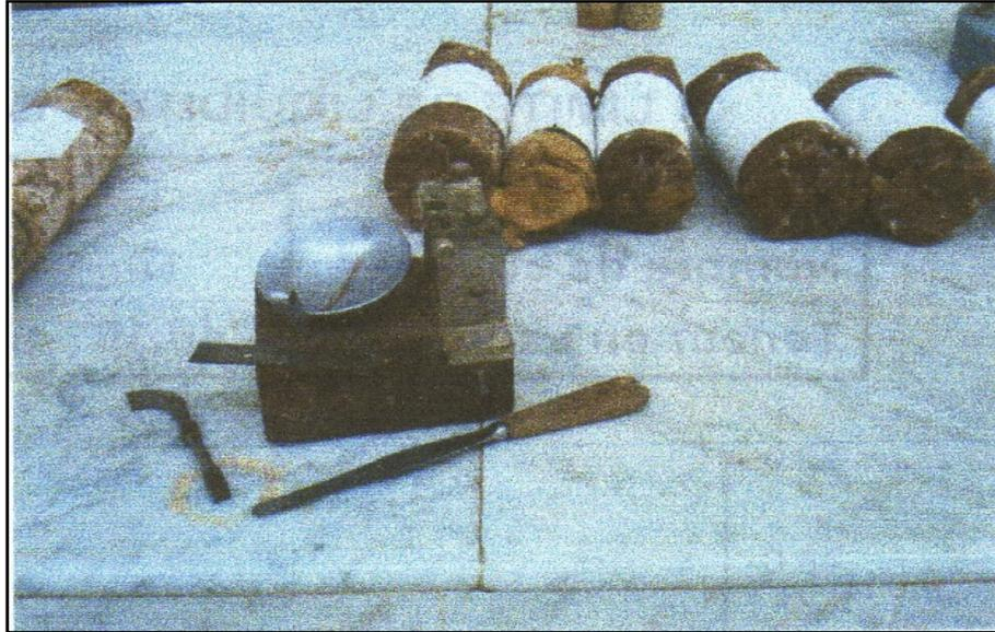
**Photo V 3.**Essai de limites d'Atterberg.
