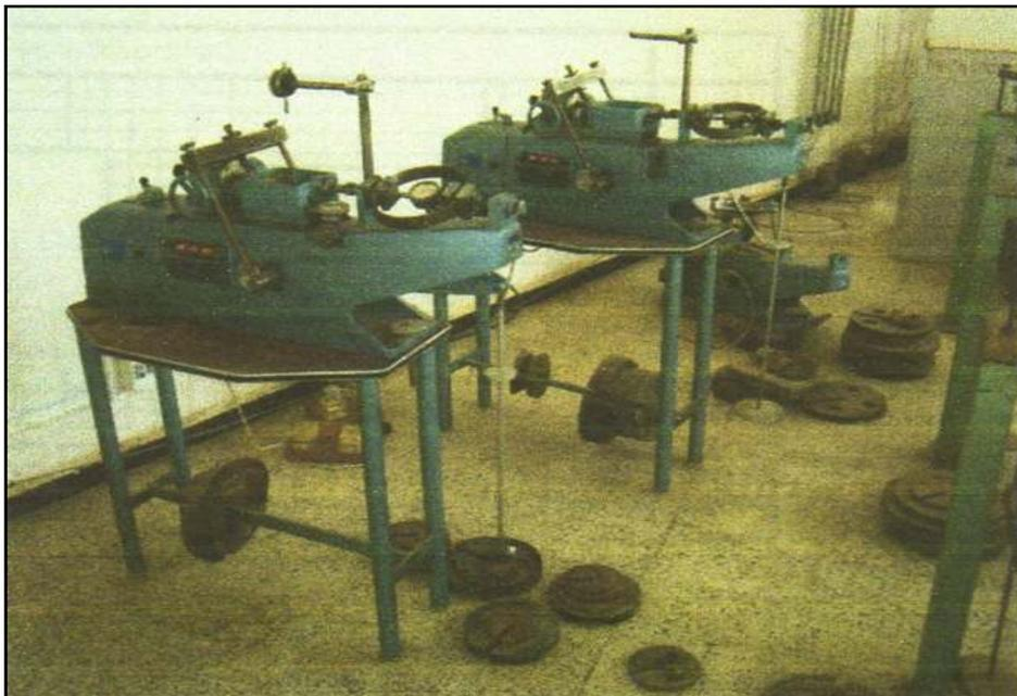
**Photo V.8.** L'appareil de cisaillement direct.
