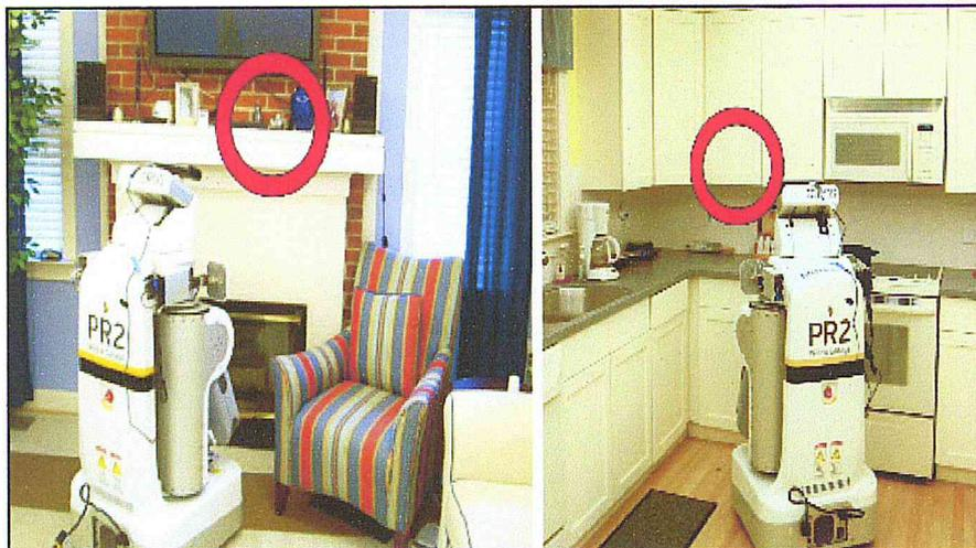
Figure 1.10 : Approchement du robot PR2 aux objets [38].
