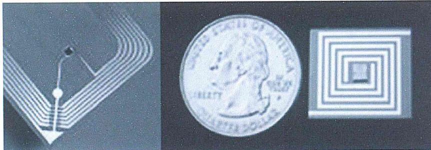
**Figure 1.7 :** *Structure et vue externe de tags RFID [14].*
