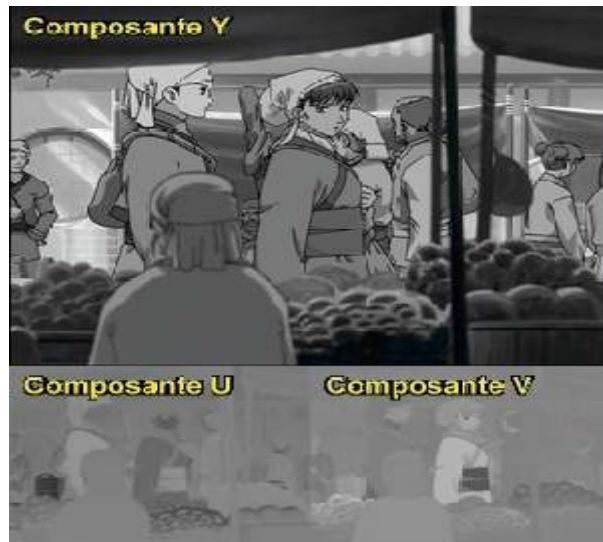
Figure.2.5 : Les composantes U et V sont sous-échantillonnées
