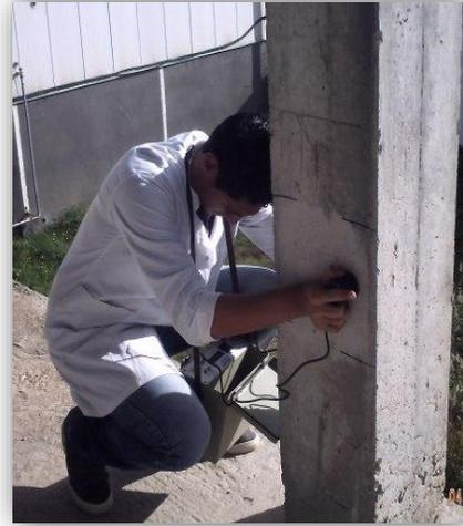
**Fig.3.10-(a)** Mesure Ultrasonique sur un Poteau
