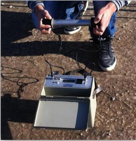
**Fig.3.9**-Etalonnage de l'ultrason
