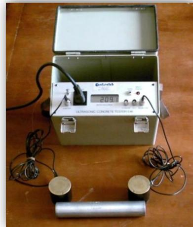
**Fig.3.4-** Ultrason utilisé.
