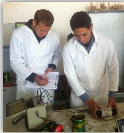
**Fig.3.15-** Mesure Ultrasonique sur Carotte
