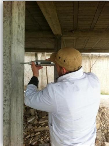
**Fig.3.8-(a)**Mesure Sclérometrique sur Poteau
