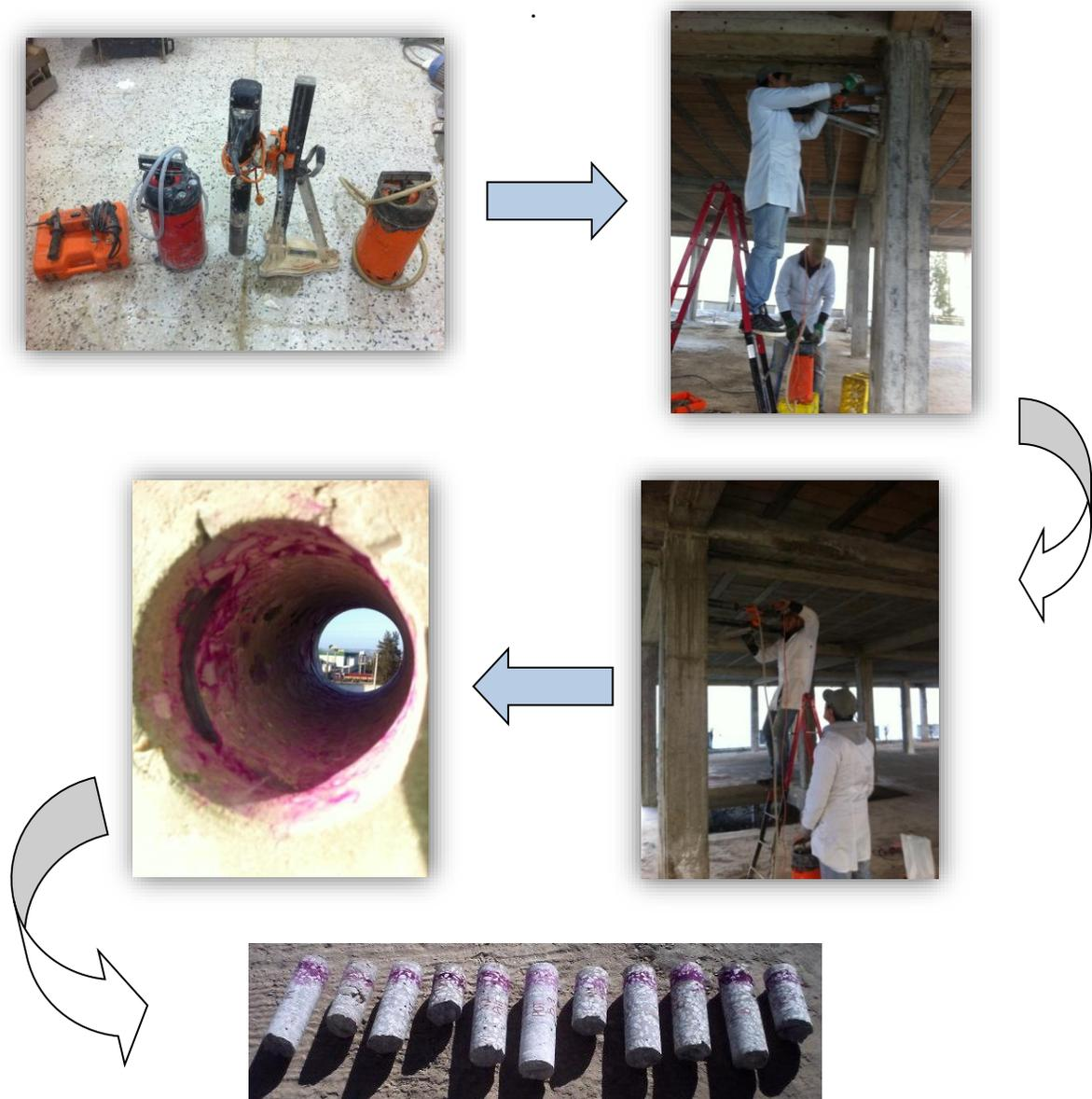
**Fig.3.11-** Exemples d'opérations de Carottage sur Poteau
