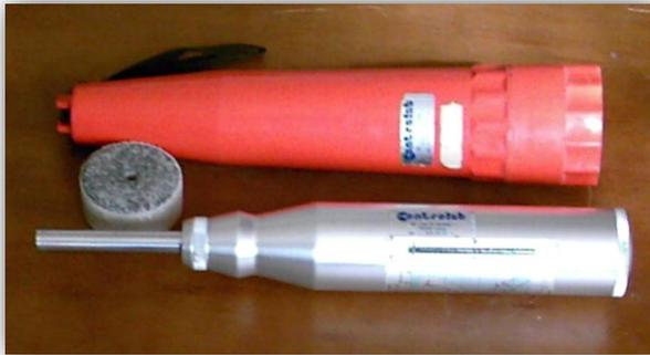
**Fig.3.3-** Scléromètre utilisé.
