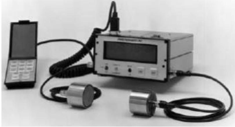
**Fig. 2.5-** Appareil de mesure de la vitesse d'impulsion [26].
