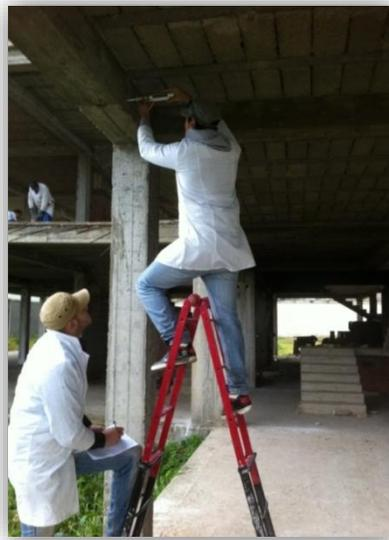
**Fig.3.8-(b)** Mesure Sclérometrique sur Poutre
