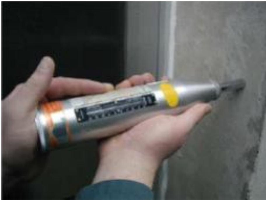
**Fig. 2.1-**Marteau de rebondissement de Schmidt de type N en cours d'utilisation.
