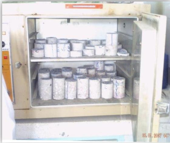
**Fig.3.21-** Morceaux de carottes dans des étuves pour séchage.
