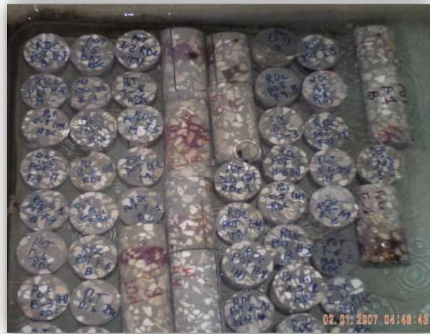
**Fig.3.22-** Morceaux de carottes dans un bassin d'eau
