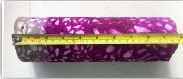
**Fig.3.13-** Mesure de la Pénétration du CO<sub>2</sub> dans le béton
