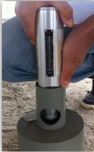
**Fig.3.7-** Etalonnage de l'appareil
