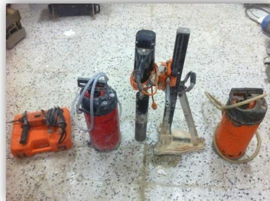
**Fig. 3.5-** Carotteuse utilisé.
