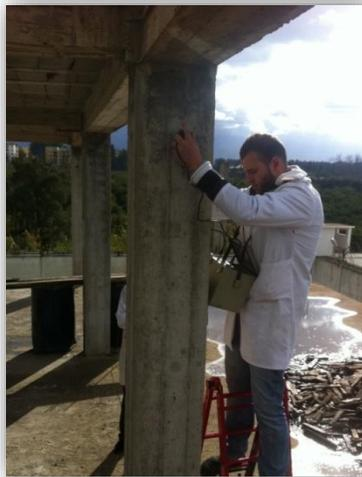
**Fig.3.10-(b)** Mesure Ultrasonique sur un Poteau
