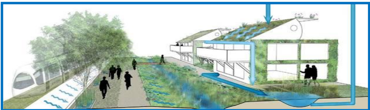
Figure 15:Réseau de récupération d'eau de pluies
