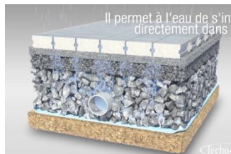
Figure 114: revêtements de sol permettant l'infiltration naturelle des eaux de ruissellement vers le nappe phréatique
