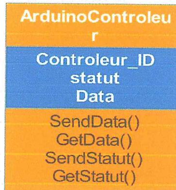
Figure 20 : classe ArduinoController
