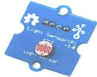
Ce module sera mis en place dans l'installation (domicile/établissement) pour mesurer la luminosité de l'environnement afin de gérer l'éclairage de l'installation selon des configurations faites par l'utilisateur [45]
