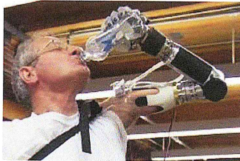
Figure 10: Contrôle de cette prothèse par la pensée : ouverture-fermeture (imagination de la main droite-gauche respectivement).
