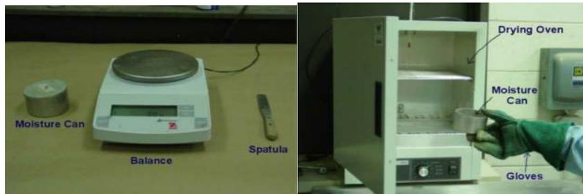
*Photo V.2 : appareillages pour mesure le Poids volumique et Teneur en eau naturelle*
