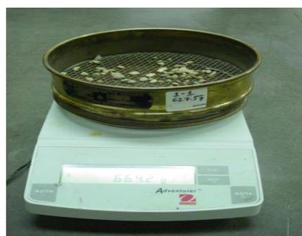
Photo V.3 : appareillages d'Analyse granulométrique par tamisage
