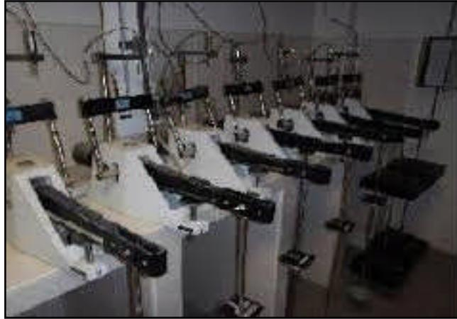
Figure 4.7: L'oedomètre (appareil pour essai de compressibilité)
