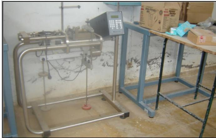
*Figure 4.6: L'appareil de cisaillement direct*
