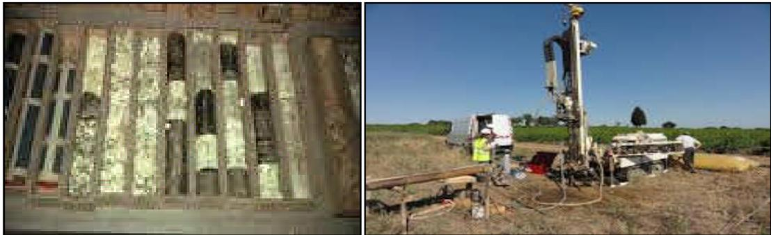
Figure 4.2: Caisse de conservation d'échantillon de sol extrait de sol / Sondeuse sur site
