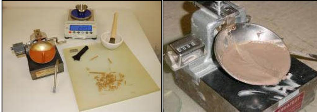
Figure 4.5: Essai de limite d'Atterberg
