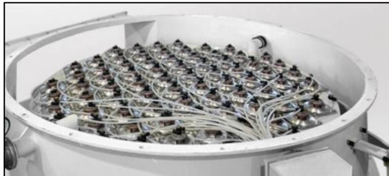
**Figure I.4** : Le compartiment air filtré [4]
