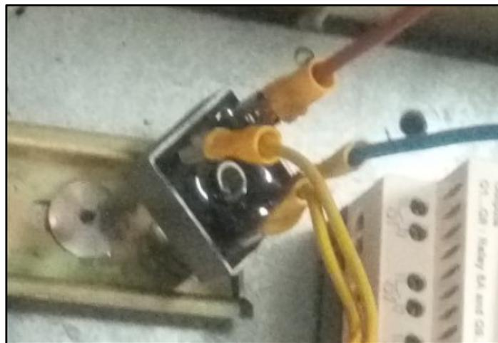
**Figure II.5:** Pont de diodes
