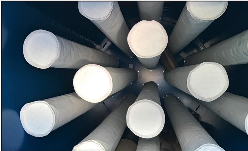
**Figure I.2** : les Manches filtrante montées [3]
