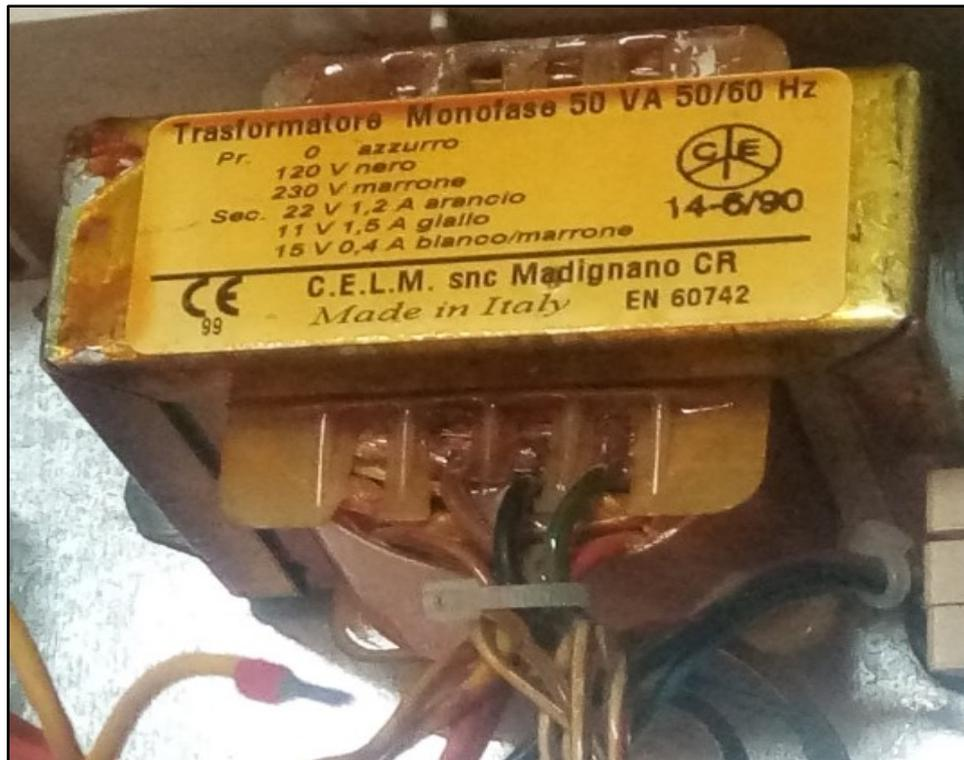
**Figure II.3** Transformateur de tension utilisé
