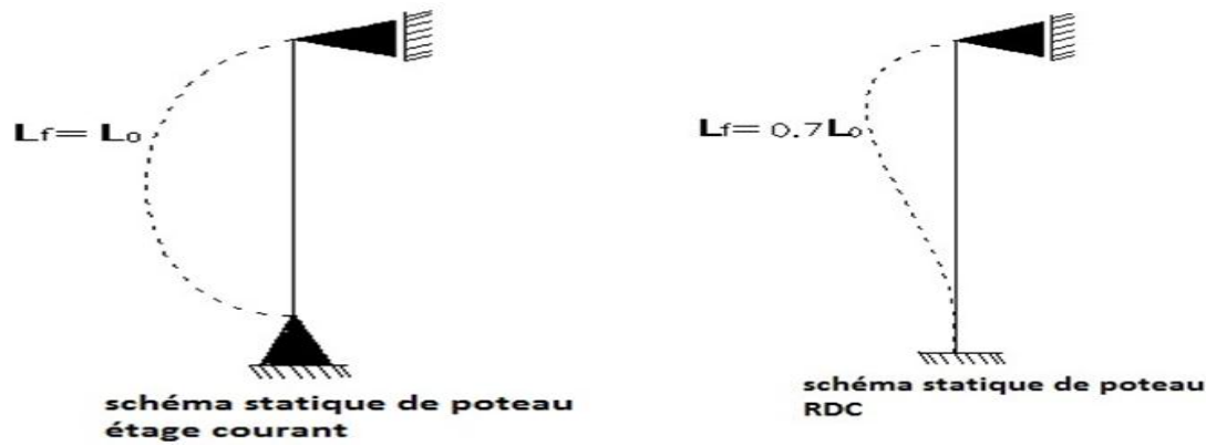
Figure IV.8: Longueur de flambement.
