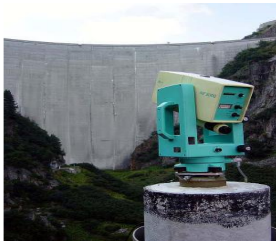
Figure 61- Appareille de mesure triangulaire (Théodolite)
