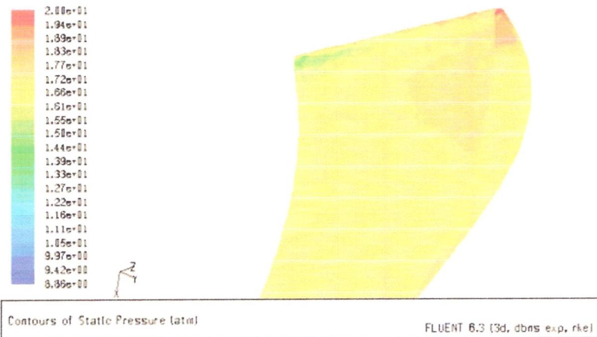
**Figure 35 : Contours de la pression statique sur l'intrados.**
