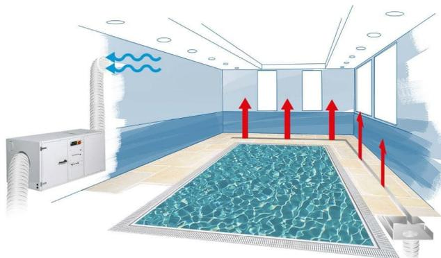
Figure 229 : Le fonctionnement d'un système de déshumidification
