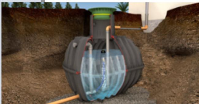
Figure 172 : Detail cuve
