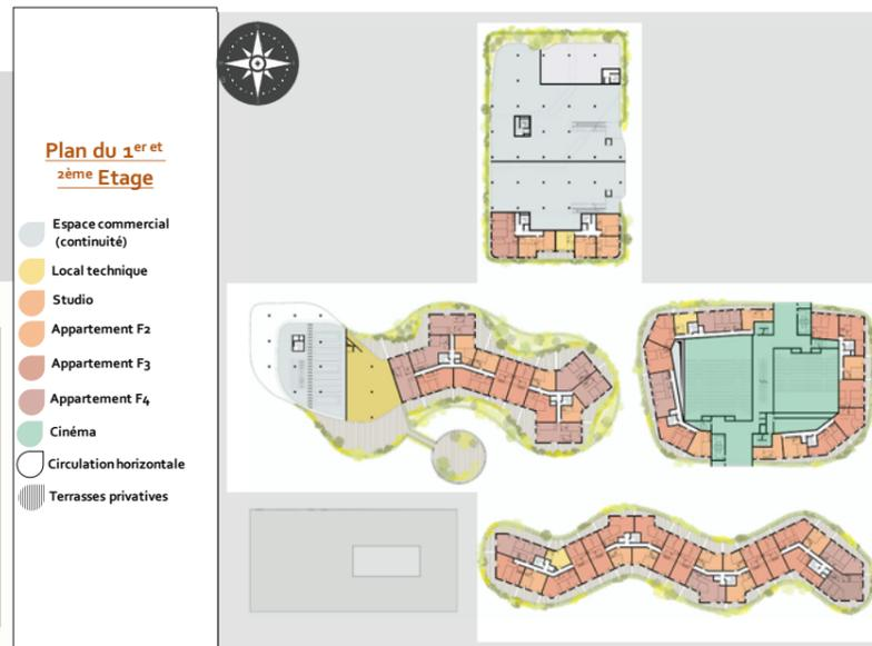
Figure 95: Illustration en plan de l'occupation fonctionnelle au 1er et 2ème étage.
