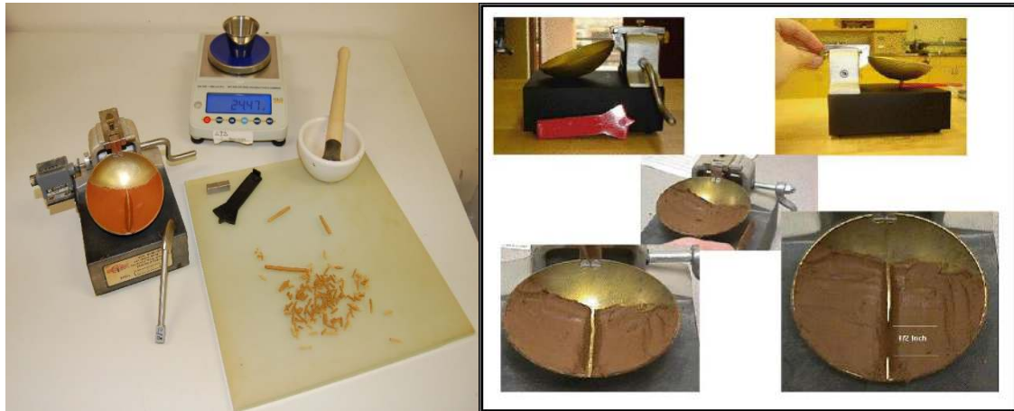
Figure III.3.2. Essai de limite d'Atterberg
