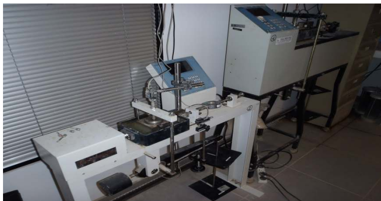
Figure III.3.2. Essai de cisaillement à la boîte
