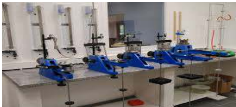
Figure III.3.2. Essais à l'odomètre.
