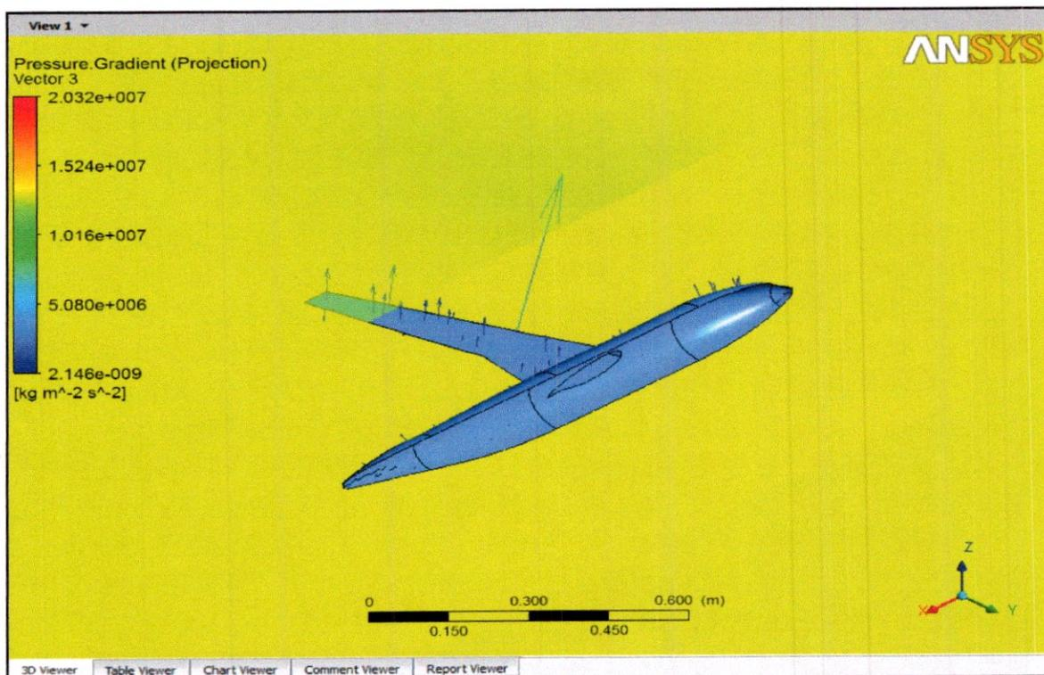
Figure 4-32 : Représentation du gradient de pression sur la configuration DLR-F4
