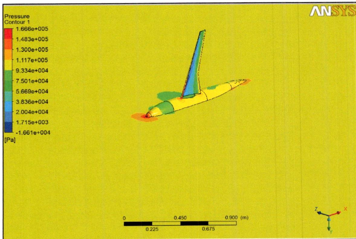
Figure 4-33 : Répartition du contour de pression de la configuration DLR-F4 (partie supérieur)
