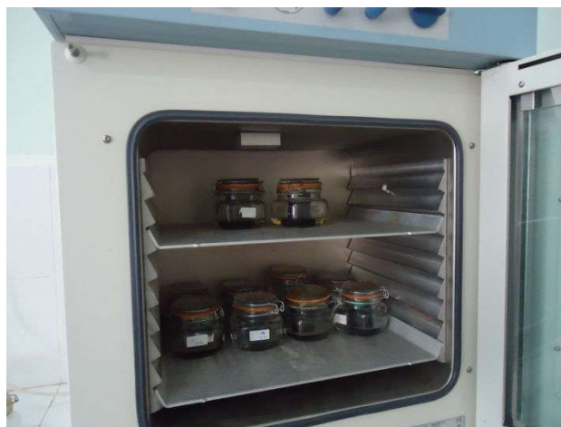
Fig.V.3. Les bocaux des solutions saline contenant les échantillons de viande et placés dans l'étuve
