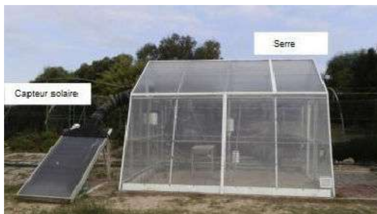
Fig.I.13.Séchoir solaire de type serre en mode mixte. [32]
