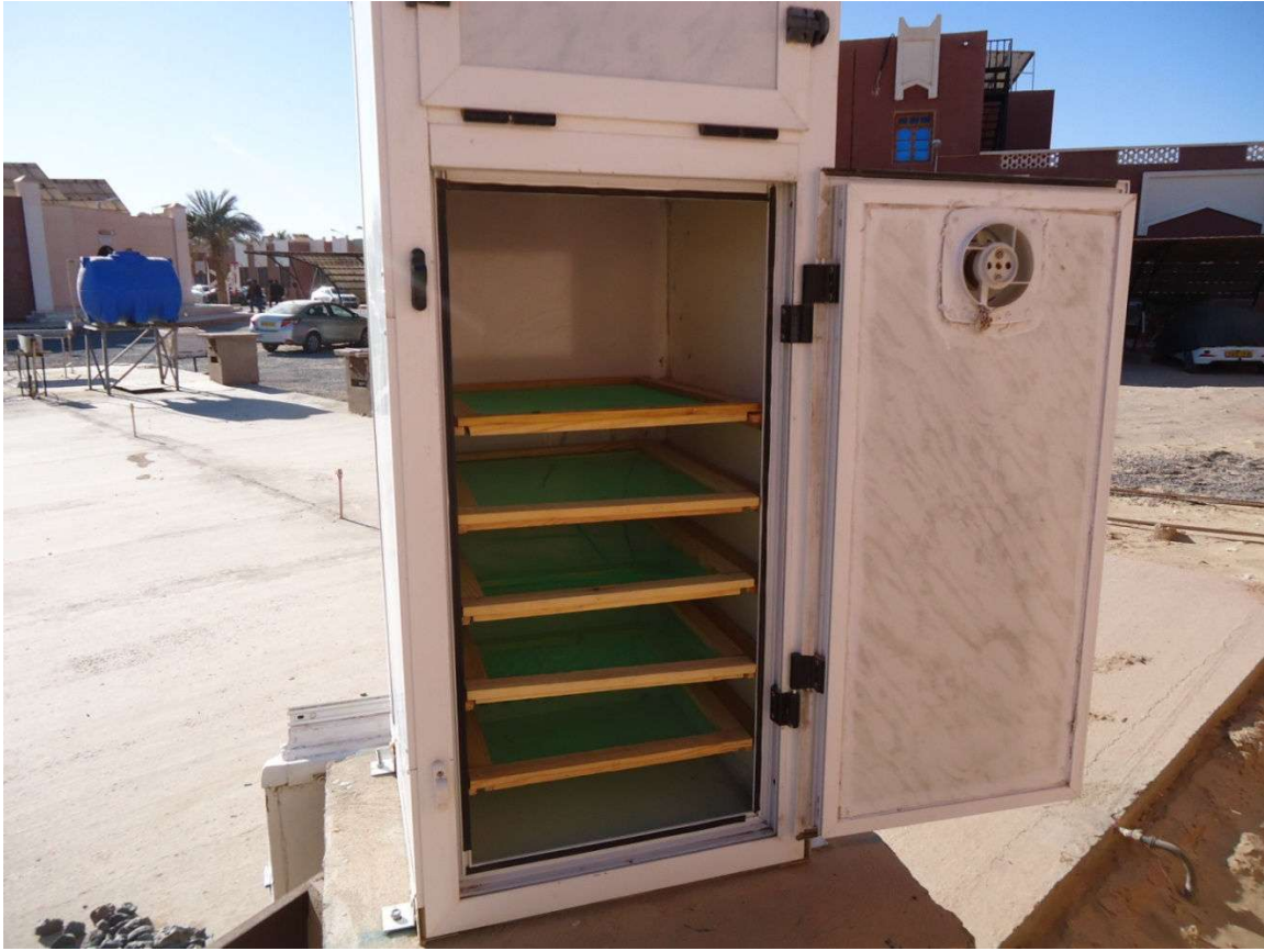
Fig.II.4. La chambre de séchage indirect
