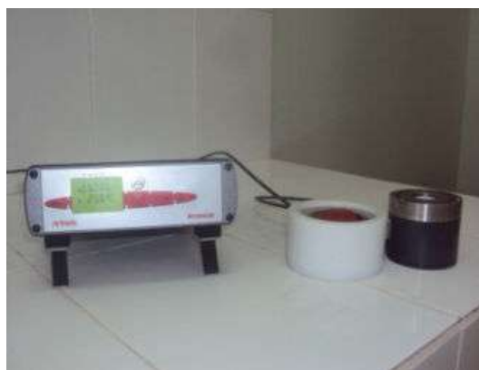
Fig.VI.2. Mesure de l'activité de l'eau avec l' a_w mètre
