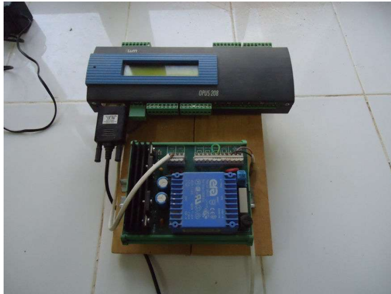
Figure IV.1. Hygromètre Opus 208 pour la mesure des humidités relatives
