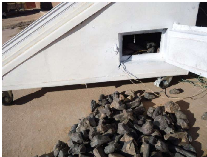
Fig.II.7. La cavité de stockage des galets placée sous le capteur solaire
