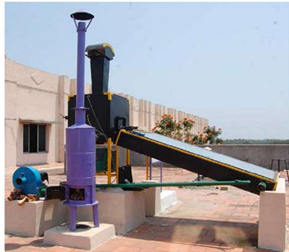
Fig.I.15. Vue schématique et photo d'un séchoir solaire hybride avec four à biomasse[33].
