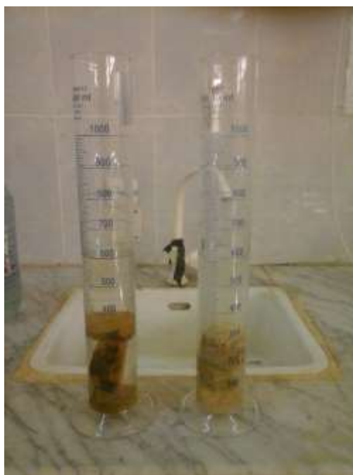
Figure 4.4 : Détermination de la masse volumique absolue par la méthode de déplacement d'eau.
