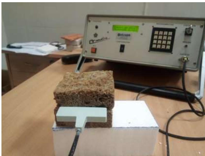
Figure 4.3 : Détermination de la conductivité thermique et chaleur spécifique à l'aide du CT Metre au niveau du CNERIB.
