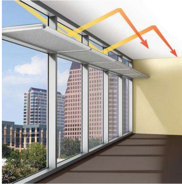
Figure 2.16 : Exemple de système de light shelves [89].
