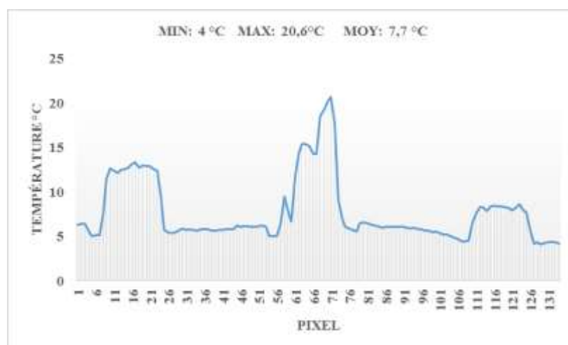
Figure 4.8 : Ponts thermiques au niveau des fenêtres de la façade est du lycée ABDOU.
