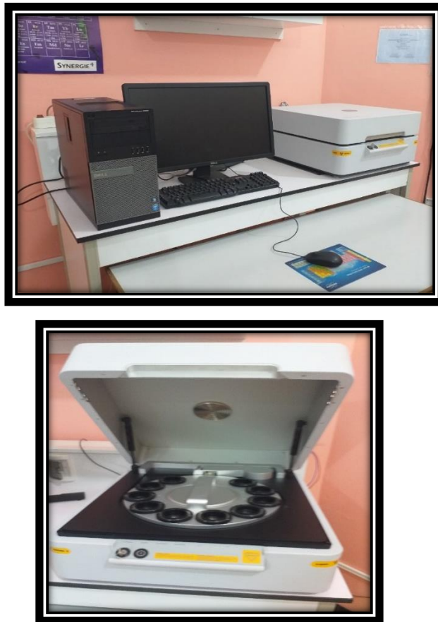
Figure 3.4 : Dispositif expérimental d'ED-XRF type Epsilon 3XL, PANalytical.
