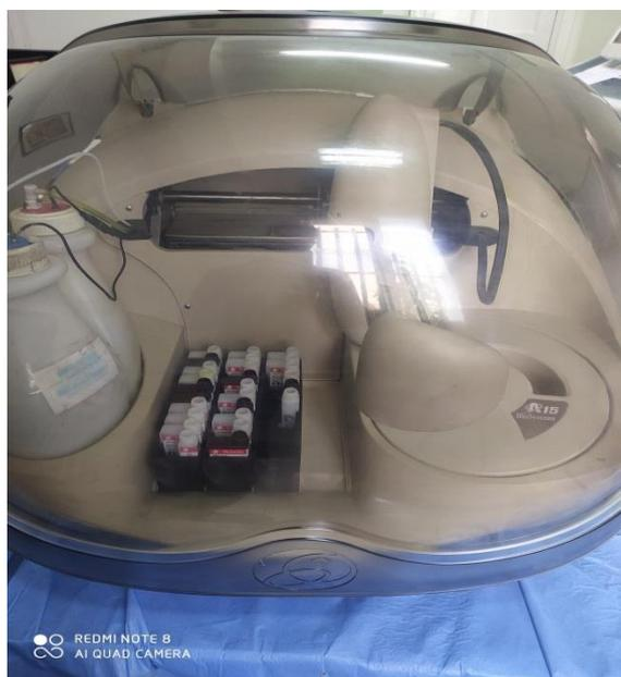
**Figure 23 :** Automate de biochimie, Biosystème, model A15.
