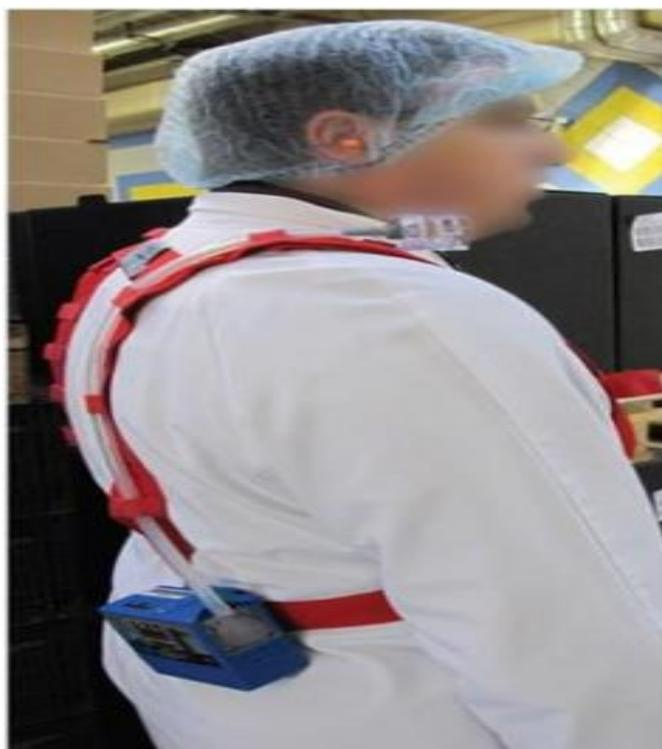
**Figure 14 :** Dispositif de prélèvement actif individuel (INRS, 2015)
