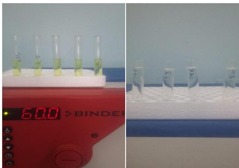
**Figure 51** : Dosage du plomb par SAA-ET. Minéralisât de sang et d'urine dilués
