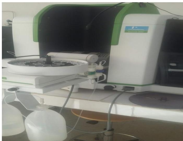
**Figure 21 :** Spectromètre d'absorption atomique. PinAAcle 900Z, Perkin Elmer
