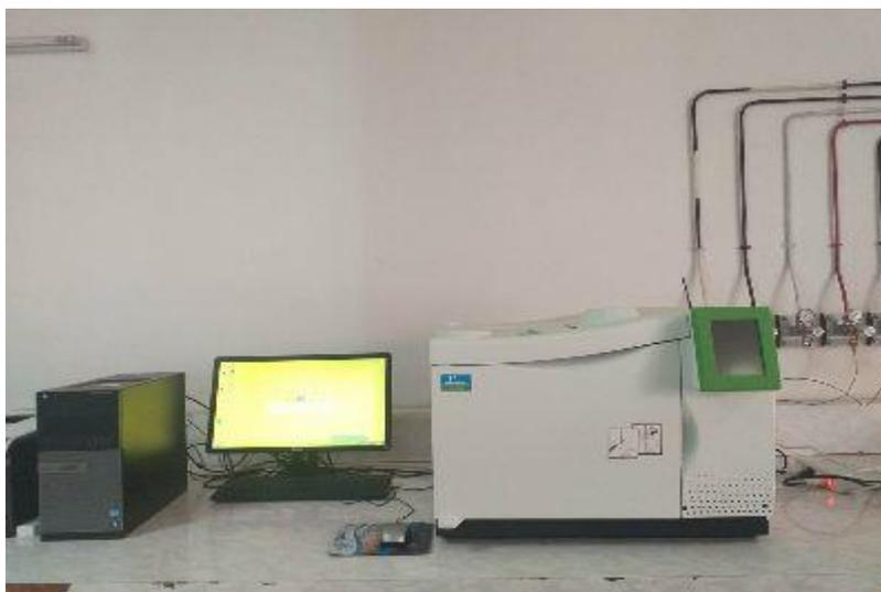
**Figure 19** : Chromatographe en phase gazeuse Perkin Elmer. CLARUS 680.
