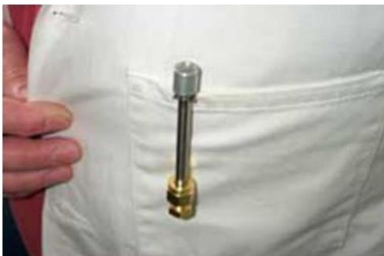
**Figure 15** : Tube de prélèvement passif axial (INRS, 2015)
