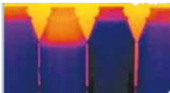
Figure 3.4. L'image thermique présente des bouteilles trop ou insuffisamment remplies [114].
