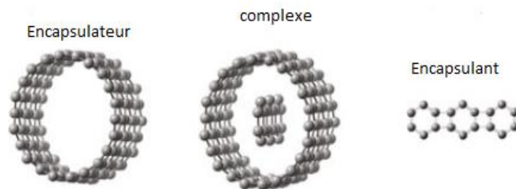
Figure 1.7 : Encapsulation d'un polymère dans un CNT [10].
